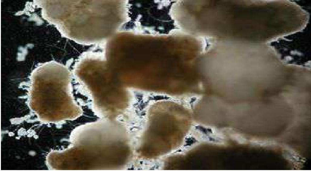
شکل (۶): گرانولی هوازی به دست آمده از کاربرد AGS در فاضلاب شهری
