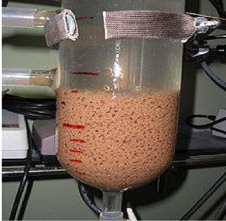
شکل (۷): راکتور نا پیوسته متوالی (SBR) با گرانولهای هوازی
