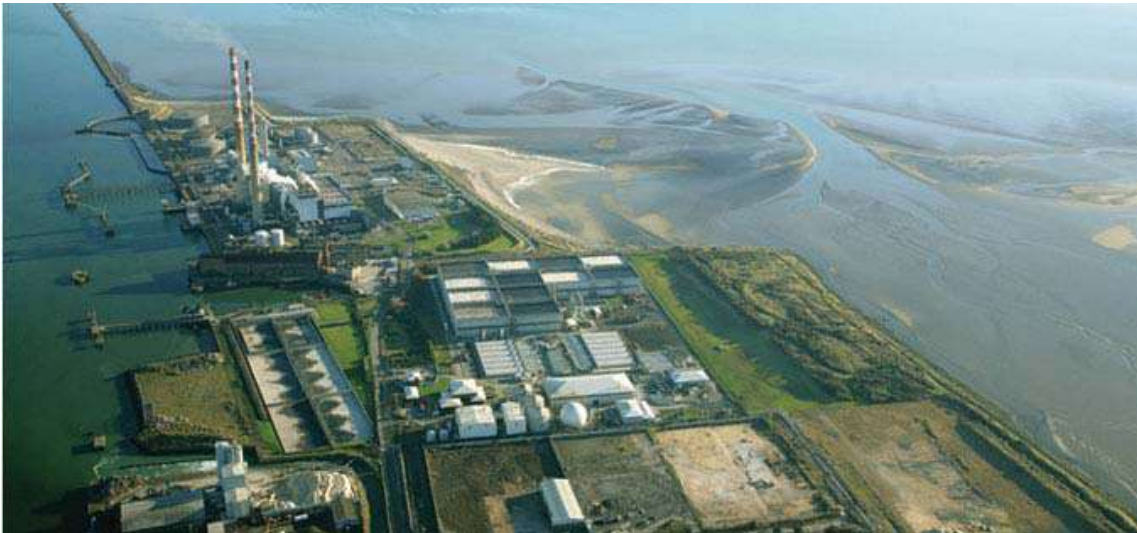
شکل (۲۱): پساب تصفیه شده توسط لوله های زیر آب به طول ۹ کیلومتر در داخل خلیج دوبلین تخلیه می‌گردد (پروژه به روزرسانی تصفیه خانه رینگسند ایرلند، ۲۰۱۶)
